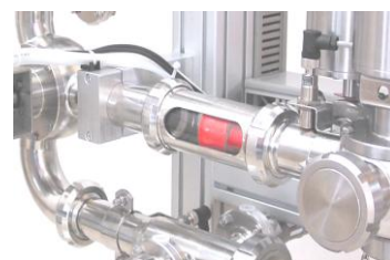
Einbaubeispiel Sichtglas Sight glass built-in situation
